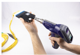
Inspección de conectores multifibra
