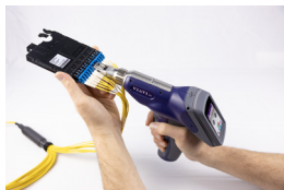
Inspección de conectores dúplex
